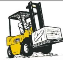
Movimente a máquina sempre com a carga inclinada para trás e os garfos na posição mais baixa possível, melhorando estabilidade e visibilidade.
