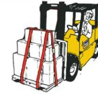
Não movimente cargas que não estejam seguras e ajustadas aos garfos. Conduza lentamente quando transportar cargas desproporcionadas.
