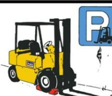
Estacione a máquina em zonas autorizadas, sempre com os garfos no solo, travando e retirando a chave da ignição.
