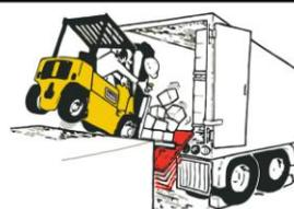
Ao manobrar num cais com plataforma confirme sempre se a mesma é suficientemente resistente e está devidamente acoplada ao camião.
