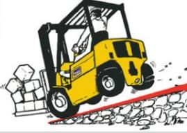
Suba a rampa frontalmente e desça de marcha atrás, sobretudo se transportar carga.
